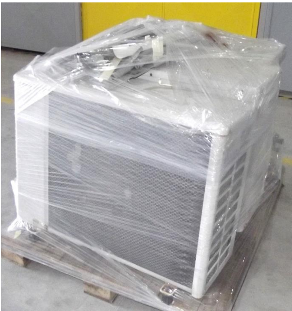
Equipamentos de ar-condicionado condensadora
